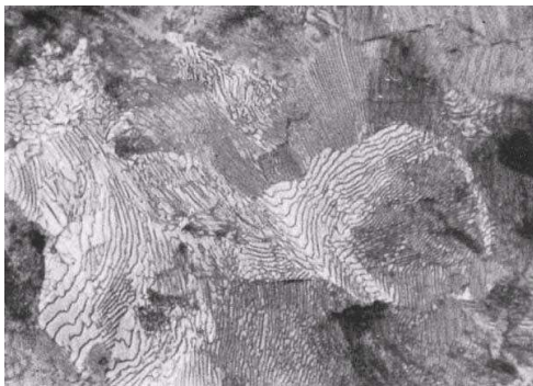
Fig. 6 : structure perlitique lamellaire Acier à 0.75%C. perlite lamellaire composée de lamelles alternées de ferrite et de cémentite
