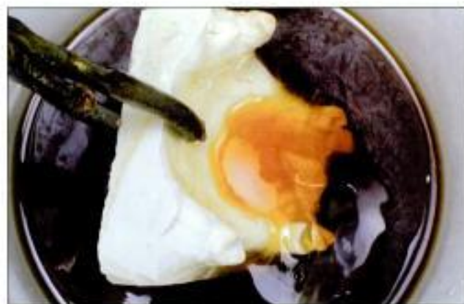
Figure 10.23 Immersion du moulage en revêtement sorti du four à 200 °C, dans un bain durcisseur (Duraform® Ugine dentaire).
