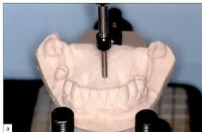
Figure 9.16 a Le moulage fixé sur le support orientable va pouvoir être analysé dans les différents plans pour répondre au maximum des exigences de conception du châssis.
