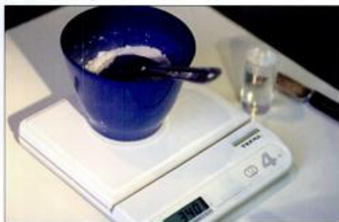
Figure 7.19 Les proportions eau-poudre données par le fabricant sont à respecter. L'adjonction de lait de plâtre diminue le temps de prise.
