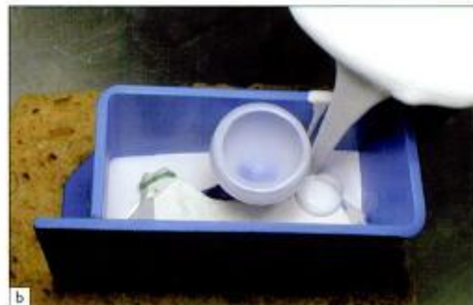
Figure 10.29 b Mise en cylindre pour coulée de titane.
