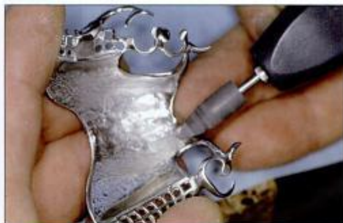
Figure 10.33 Le polissage est obtenu, pour le cobalt-chrome par l'utilisation de pointes montées en silicone et de bains électrolytiques.
