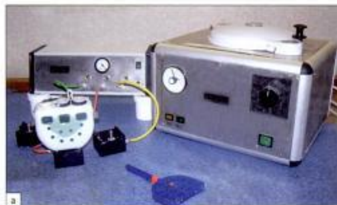
Figure 10.51 a Une partie du matériel nécessaire : la pompe à vide, le moufle, le panier d'ébouillantage des dents et le polymériseur.
