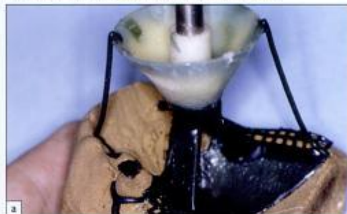
Figure 10.28 a Exemple de mise en place de tiges et cône de coulée pour un alliage cobalt-chrome.
