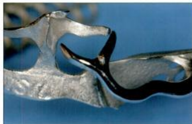
Figure 2.7 État de surface inacceptable : la rugosité de surface retient la plaque bactérienne.
