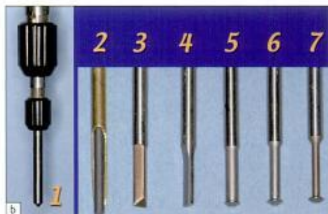
Figure 9.1 b Les accessoires sur le tube porte-mine avec mandrin : la tige d'analyse (1) et de gauche à droite : le porte-mine (2), le couteau à cire (3), le porte-ancrage (4), les jauges de retrait de 0,25, 0,5 et 0,75 mm (5, 6 et 7).
