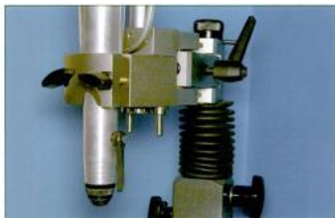
Figure 5.21 Pièce à main intégrée à un paralléliseur (document P. Santoni).
