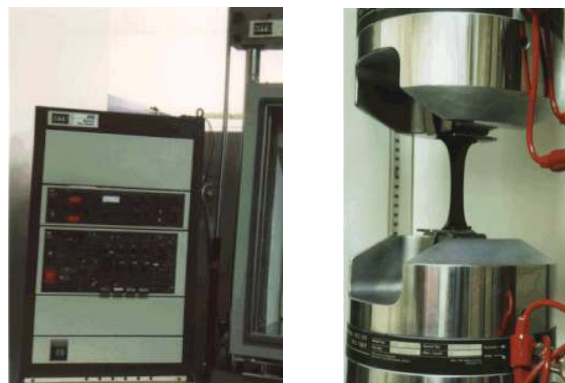
FIGURE 4.2 – Machine de traction M.T.S. avec son système d'acquisition
