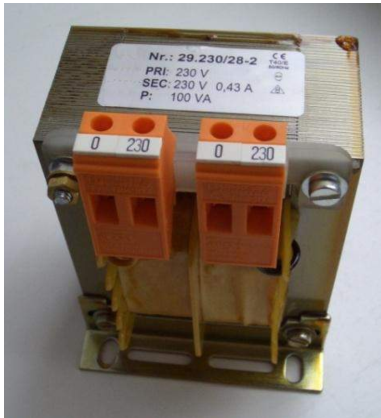
Figure 1.27. Transformateur monophasé d'isolation (230/230, 100VA).
