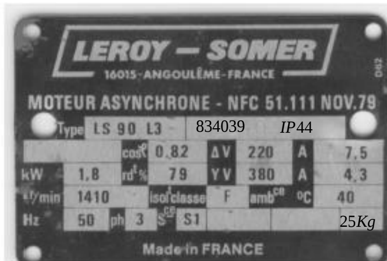
Figure 6 – Plaque signalétique d'une machine asynchrone.
