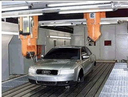
Double tête de fraisage pour usiner les maquettes de voiture en résine
