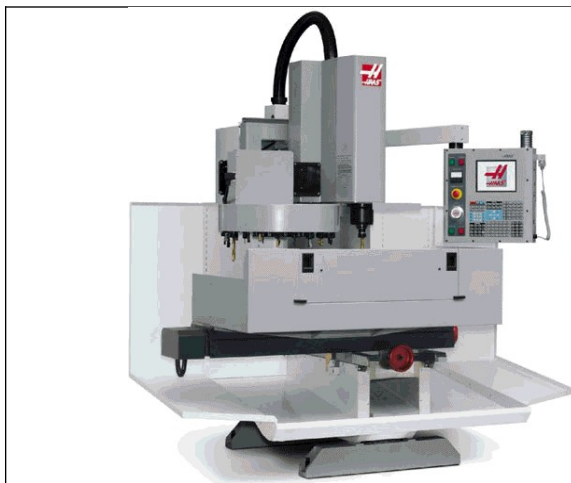
Centre de fraisage à axe vertical. On voit le changeur d'outil sur la gauche.
