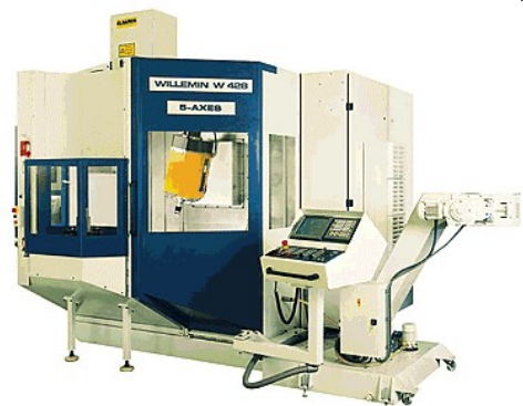
Centre de fraisage 5 axes Willemijn. La broche peut pivoter autour de l'axe X et de l'axe Y.
