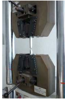
FIGURE 9 – Machine d'essai de traction avec éprouvette [4]
