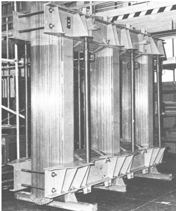
FIGURE 1.34 – Circuit magnétique à 3 colonnes, transformateur triphasé à flux liés.
